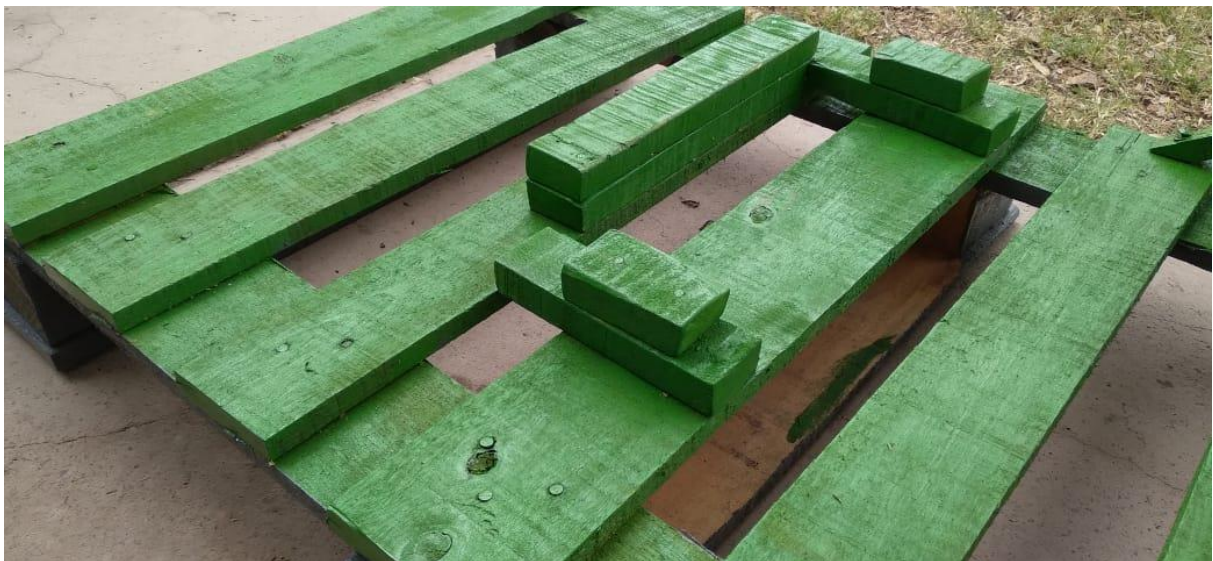
Figura 4. Detalle de las guías horizontales al pallet. Soporte del tacho.
