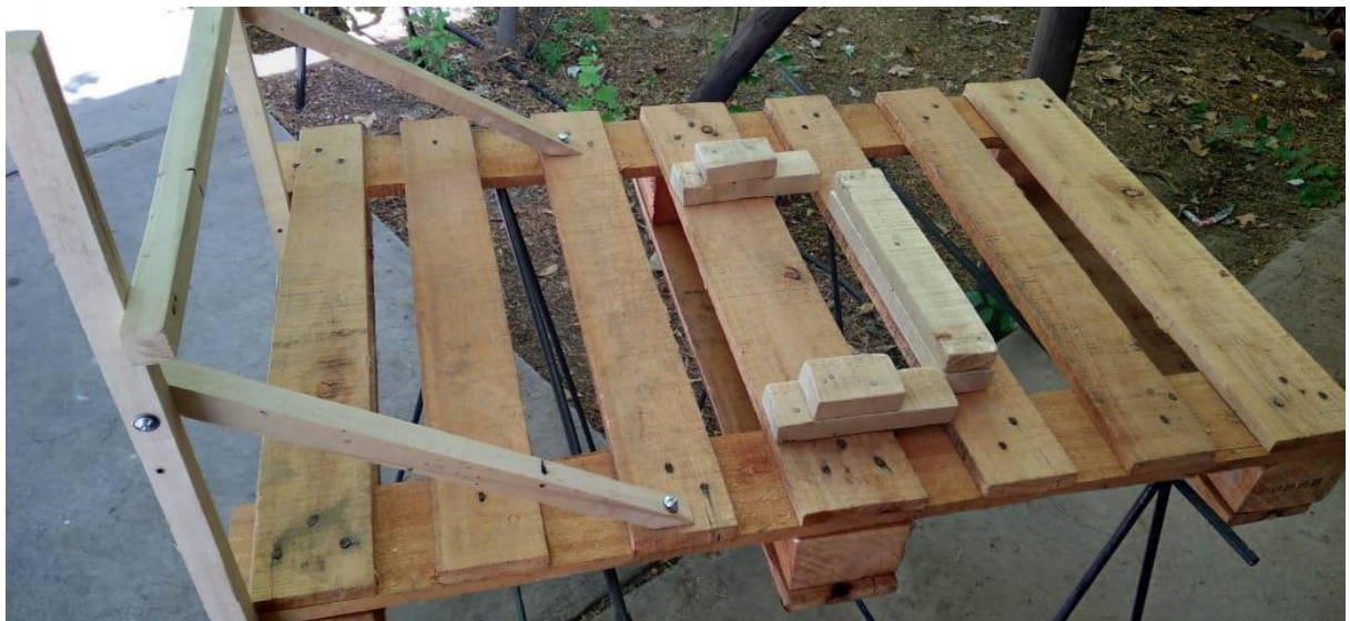
Figura 2. El soporte de madera que se uso es de 1” x 1”. Detalle: lado izquierdo de la foto.
