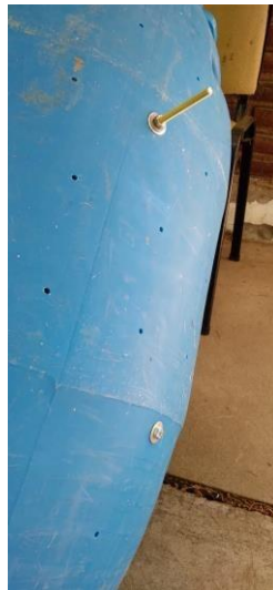
Figura 8. Colocación de la manija externa armada con tornillo pasante de 10-15 cm de largo. Parte superior del cilindro.
