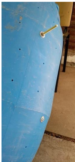
Figura 5. Agujeros para el drenaje de agua en todo el cilindro.
