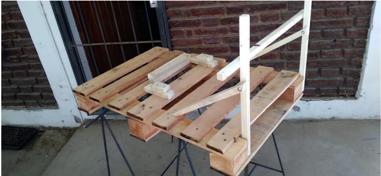
Figura 3. Las alfajías de 2" x 1,5" se clavan sobre el pallet formando una U.
