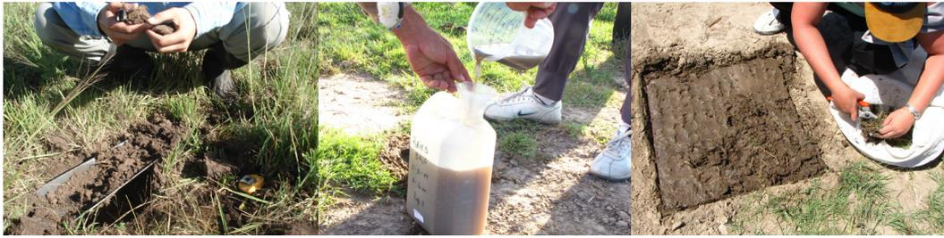
**Figura 3.** Muestro de suelo (a), recolección de escurrimientos (b) y extracción de la biomasa aérea sobre el suelo (c).
