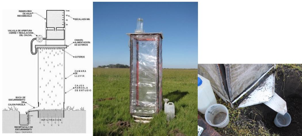
**Figura 2.** Esquema y foto del microsimitador de lluvia, salida de escurrimientos.
