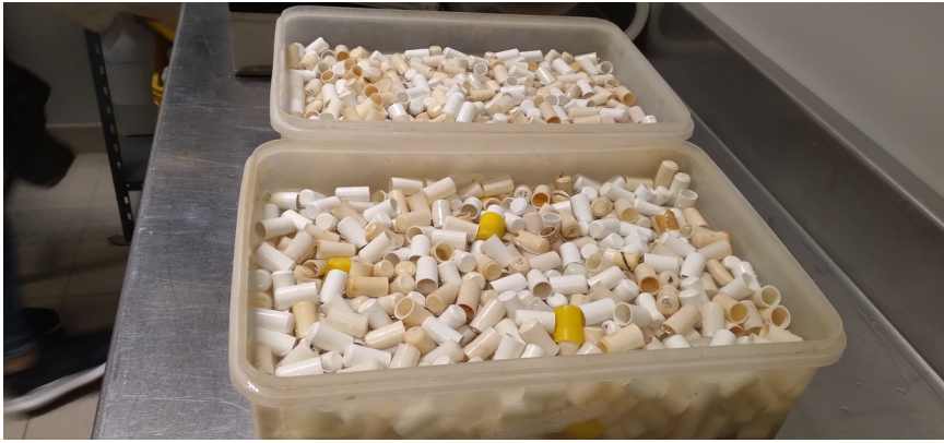
Figura 5. Tapas bacteriológicas de plástico con tratamiento de desinfección de 0,1% de cloro activo.
