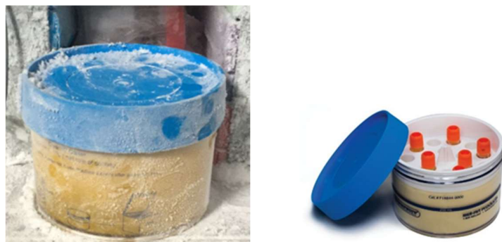
Figura 6: Contenedor con solución de isopropanol para el descenso gradual de la temperatura antes de la conservación del material biológico a -196^{\circ}\text{C} en nitrógeno líquido.
