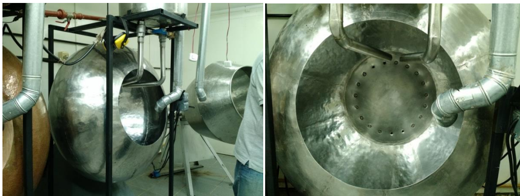
Figura 1. Bombo con conductos para soplado con aire
