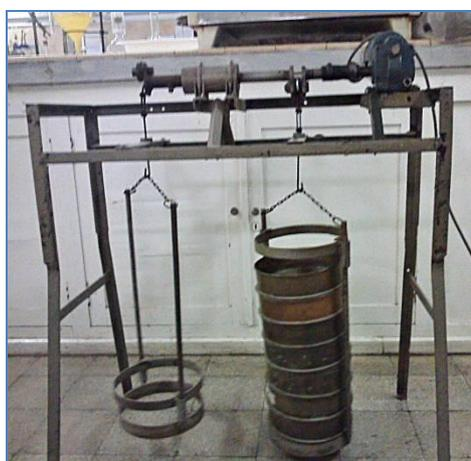
**Figura 1:** Conjunto de tamices utilizados en la desagregación de los terrones secos.
