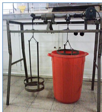
**Figura 2:** Equipo "Yoder" utilizado para el tamizado en húmedo.
