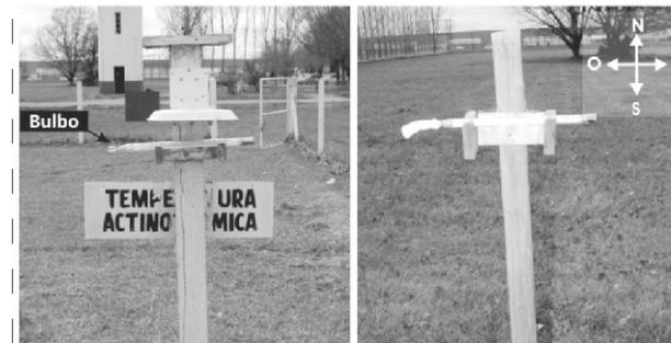
Figura 2: Mástil termométrico
