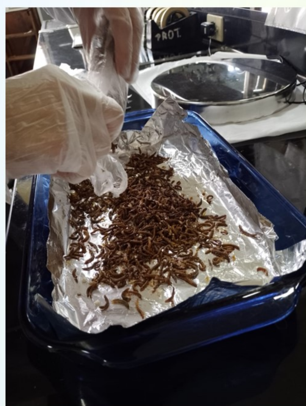
Secado de las Larvas de Tenebrio molitor : en una estufa a temperatura constante (102 °C - 2h 30min)
