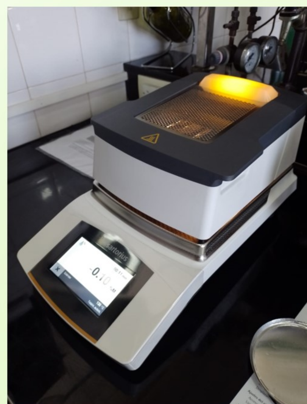
Medición de humedad: se utilizó una termobalanza (Sartorius Moisture Analyzer)
