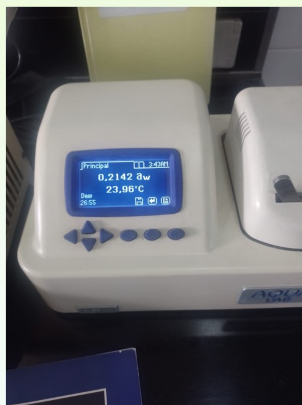
Medición de actividad de agua: se utilizó un equipo AquaLab Water Activity Meter
