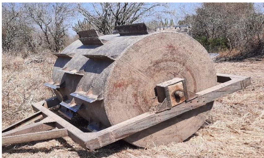
Figura 13: Rolos y tractor utilizados por el productor, tractor con rolo pequeño (primera foto); rolo pequeño con agregado de peso (segunda foto) para favorecer el corte de la leñosa; tractor y rolo de 2,5m usado en los lotes de media loma y bajo (tercera y cuarta foto).
