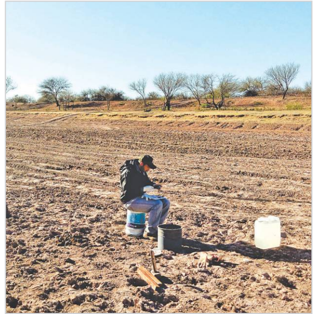
Figura 2. Detalle de infiltrómetro de anillo simple en ensayos de infiltración en fondo de represa.
