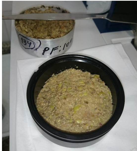
Muestra de pasta de aceituna cargada en copa para lectura en NIRs.
