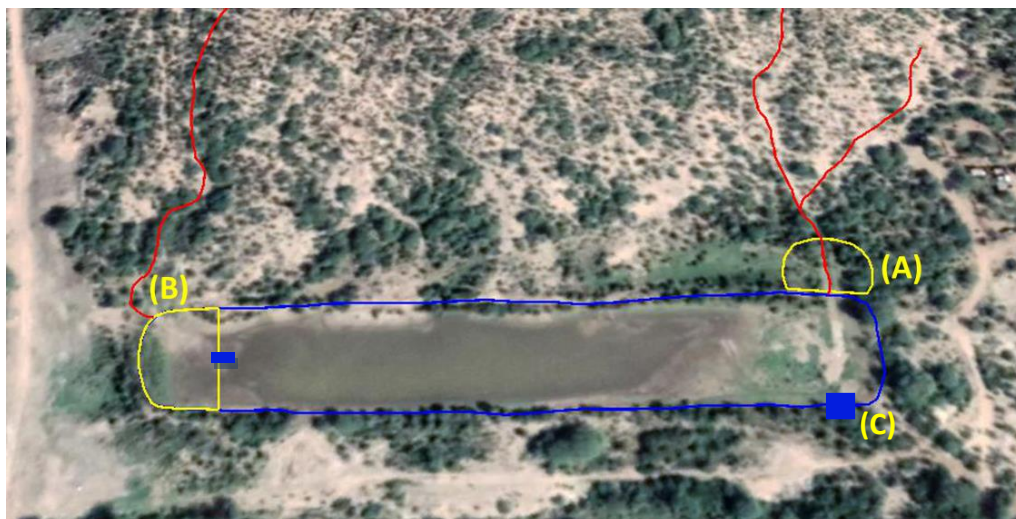
Imagen 6: Represa comunitaria próxima al acceso de la Villa Santa Rita de Catuna, detalles de estructuras necesarias para mejorar capacidad de almacenamiento (A y B - desarenadores; C - desagüe).
