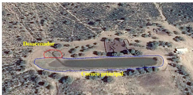
Imagen 3: Detalles cuerpo principal y ubicación de desarenador, represa ganadera Flia. Oropel, Villa Sta. Rita.
