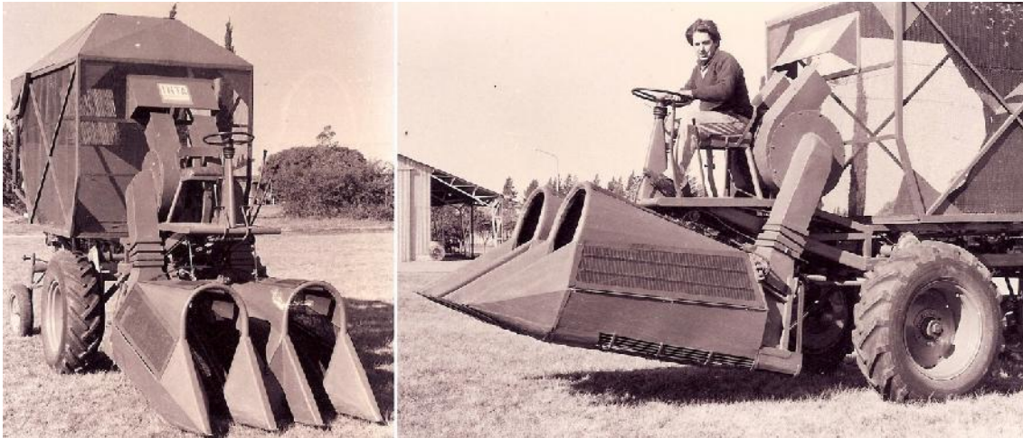
Figura 18. Primera cosechadora autopropulsada stripper desarrollada en la EEA Reconquista, siendo probada por Victor Ferezin durante el año 1975.
