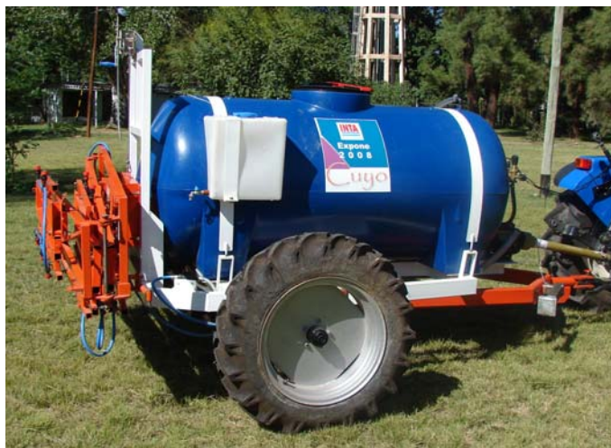
Figura 15 - Tanque de polietileno es especialmente adaptado para pulverizadoras
