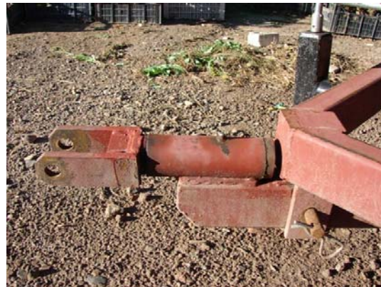
Figura 4 - Chasis, eje, lanza de tiro y acople rápido Figura 5 - Lanza de tiro y mecanismo de desacople
