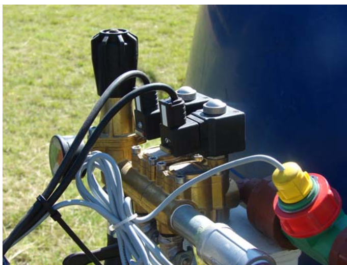
Figura 19 - Regulador de presión y electroválvulas.
