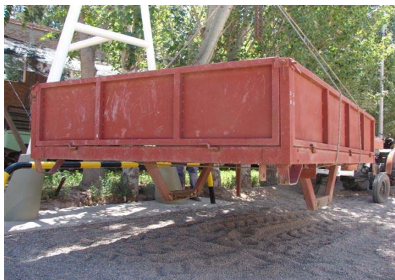
Figura 14 – Planchada con barandas y sistema macho de acople rápido
