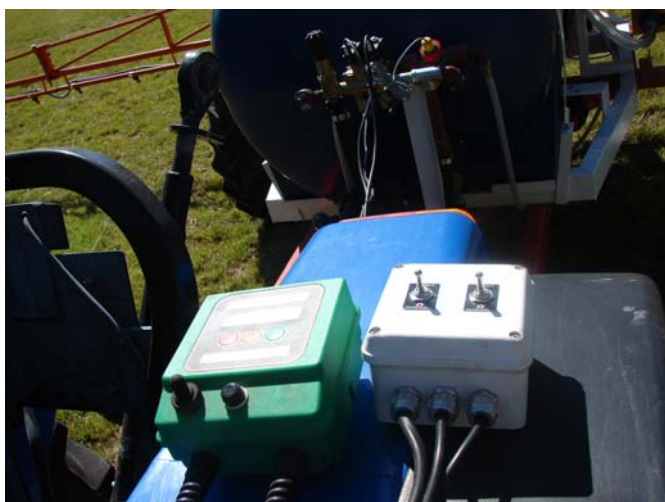
Figura 18 - Interruptores del sistema de pulverización en habitáculo
