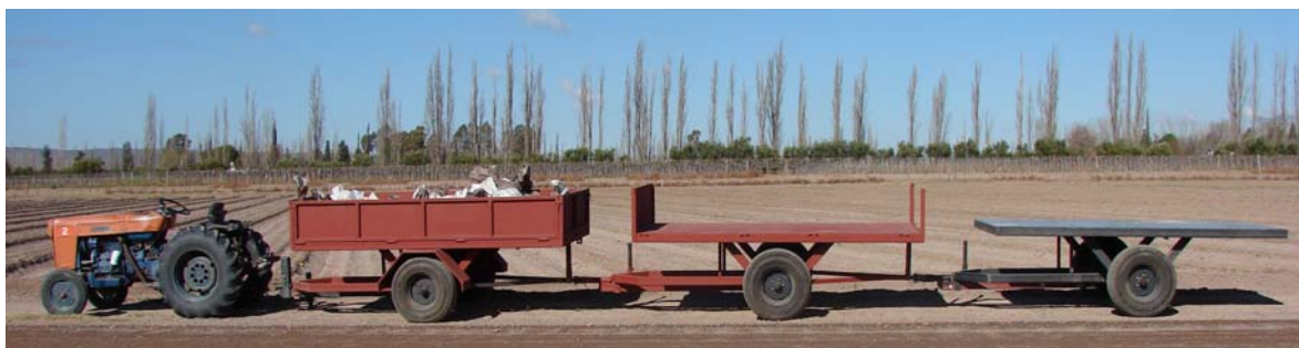
Figura 12 - Equipo en tandem: primer módulo armado como acoplado convencional y tercer módulo armado solo como planchada de carga.
