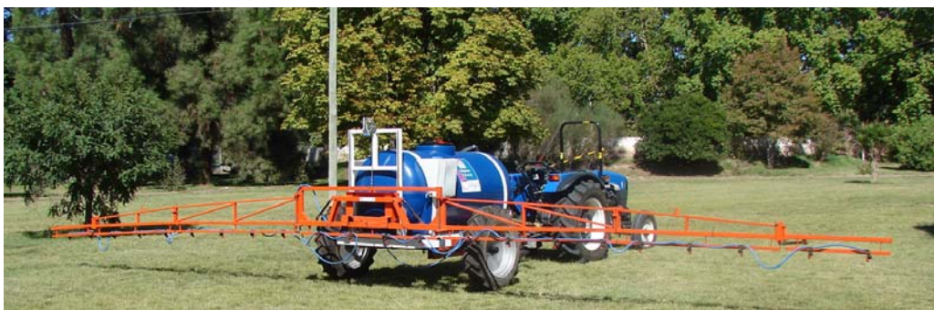
Figura 16 - Aguilones de tipo retráctil en posición de trabajo
