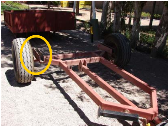
Figura 4 - Chasis, eje, lanza de tiro y acople rápido Figura 5 - Lanza de tiro y mecanismo de desacople
