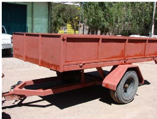
Figura 13 – Módulo armado como acoplado de carga general autovolcador
