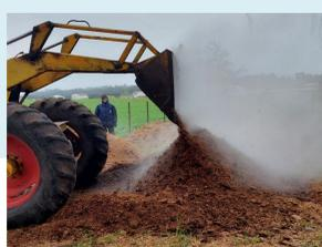
**CAM<sub>30</sub>**: pilas con aireación mecánica y agregado de viruta para una C:N=30:1
