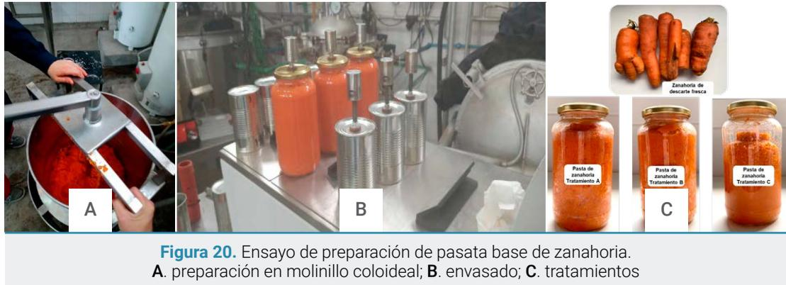
**Figura 20.** Ensayo de preparación de pasata base de zanahoria. A. preparación en molinillo coloidal; B. envasado; C. tratamientos
