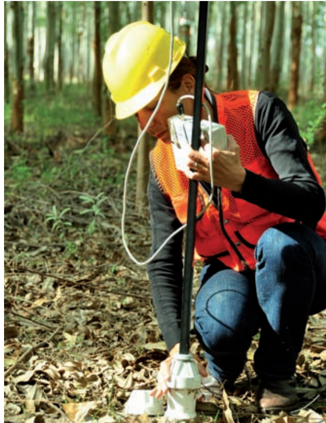
Medición del contenido de agua en el suelo con sonda de capacitancia portátil (Sentek Diviner) en plantación comercial de E. grandis
