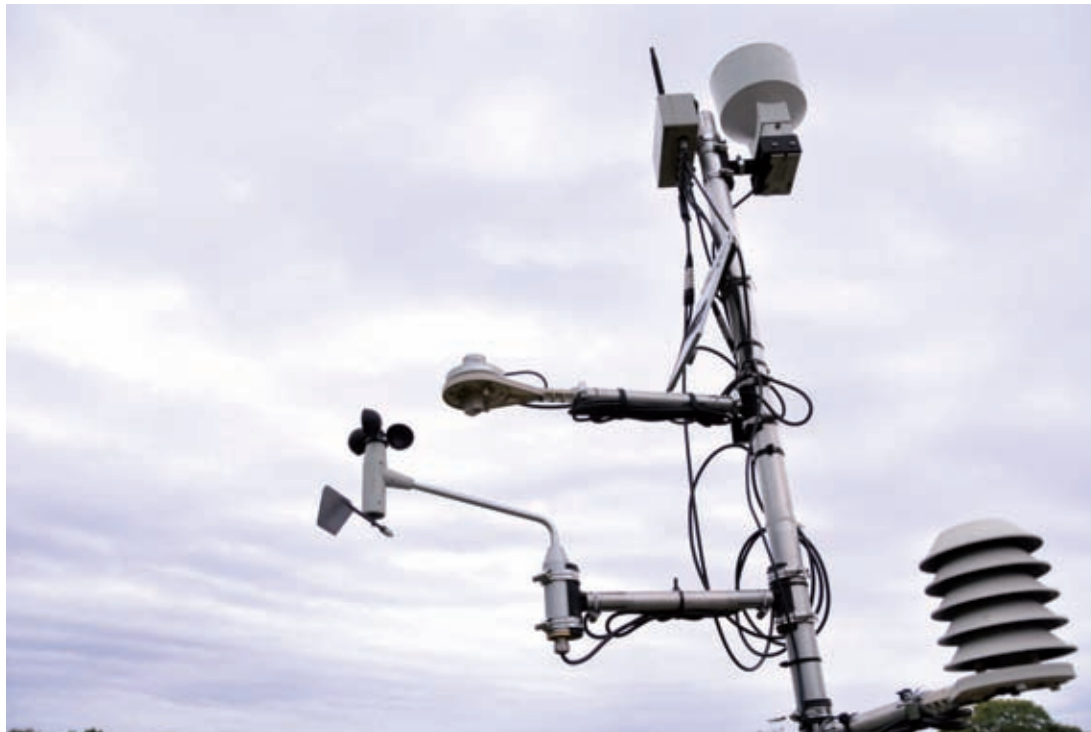
Estación agrometeorológica automática ADCON instalada en 2006 en la EEA Concordia
