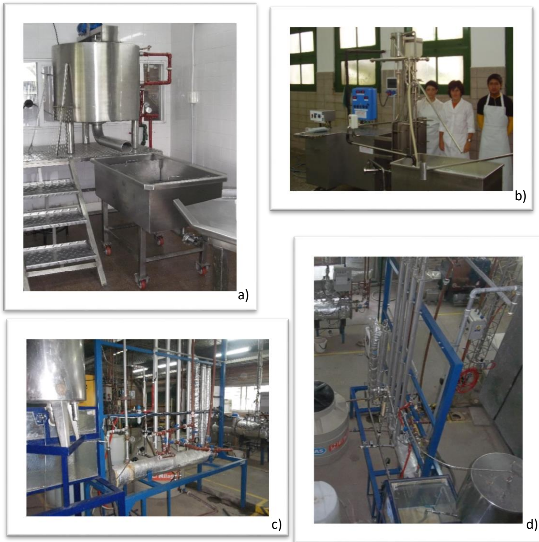
Figura 2.3.2. Equipos de tratamiento térmico de leche. a) Tina quesera con camisa de agua (pasteurización baja). b) Equipo intercambiador de calor a placa (pasteurización PM). c) Equipo intercambiador tubular (HTCT) vista horizontal. d) Equipo intercambiador tubular (HTCT) vista vertical.
