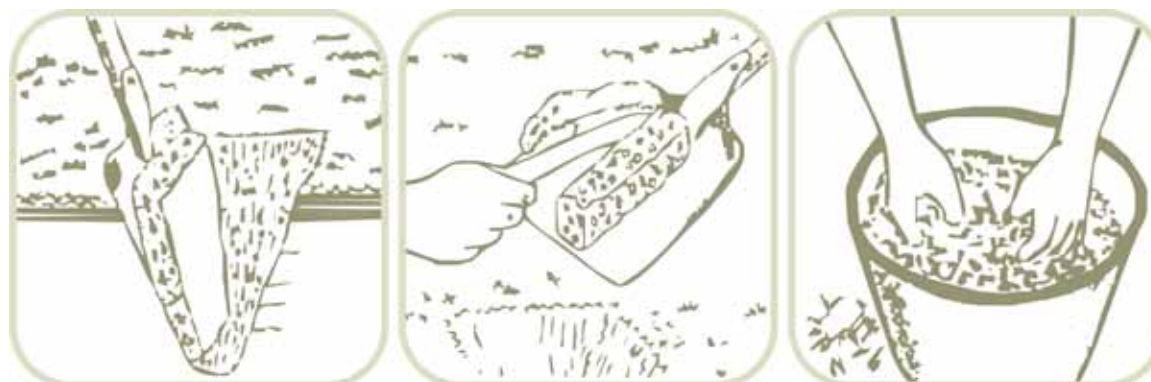
Figura 6.3. Esquema de extracción de muestras de una pala o barreno
