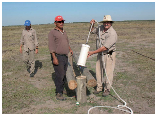
Fig 3: Sistema C: chupadores flotantes en perforaciones doble propósito y regueras helicoidales.
