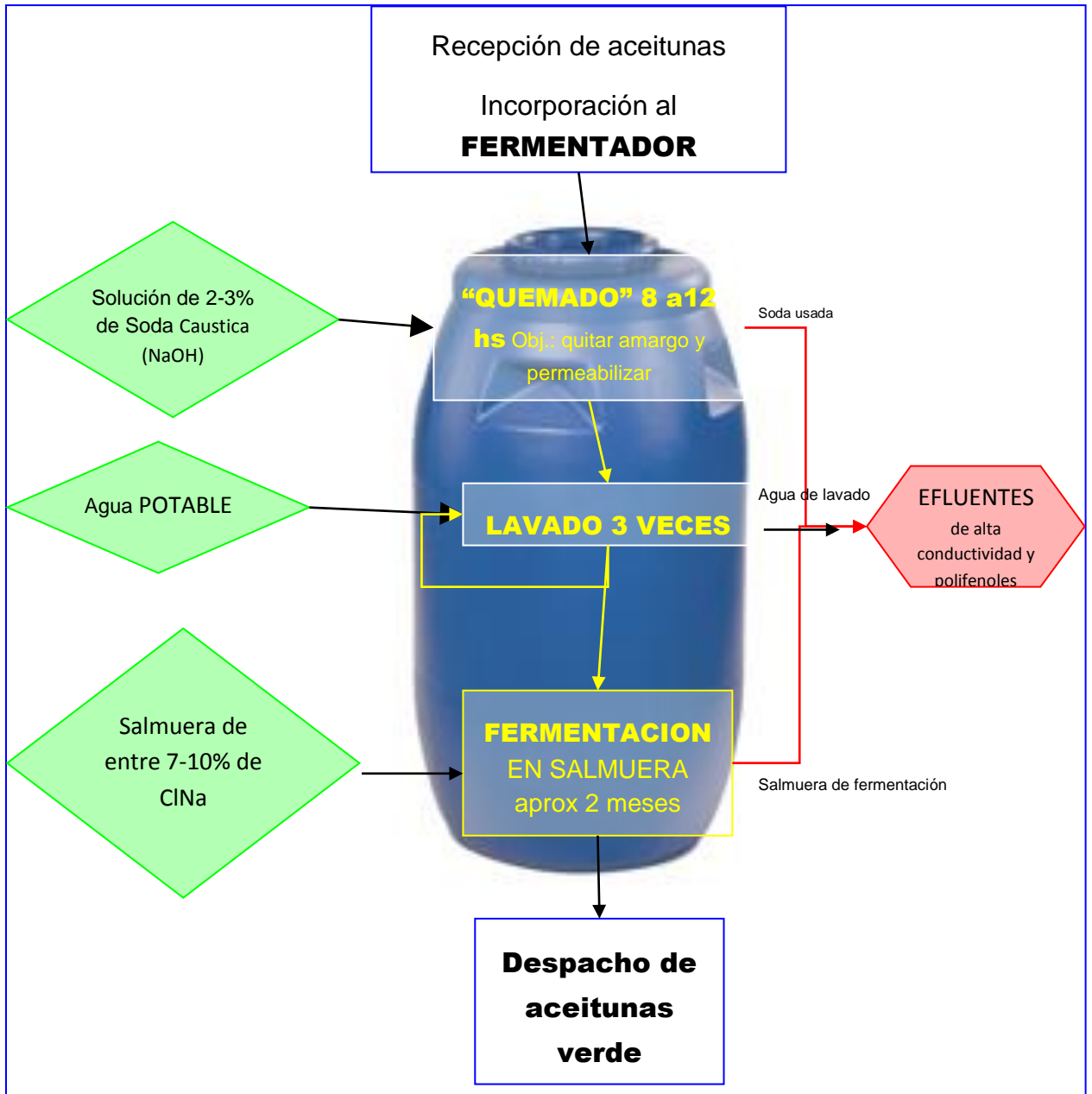
Figura 7 Diagrama de la Elaboración de aceitunas verdes en fermentadas. Fuente propia.
