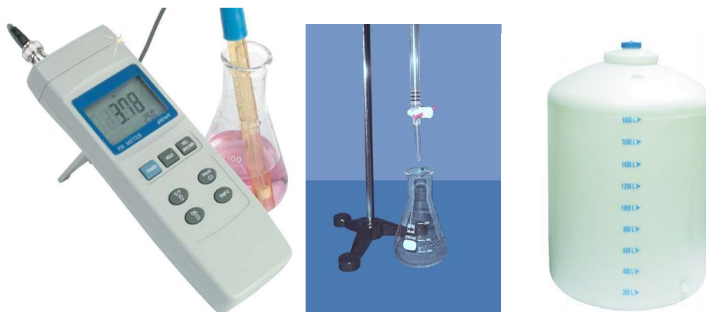
Figura12 pH metro para determinar el gasto para la neutralización de la soda – Bureta Titulando en un Erlenmeyer – Tanque graduado para el almacenamiento de la soda usada. Fuente Google imágenes.
