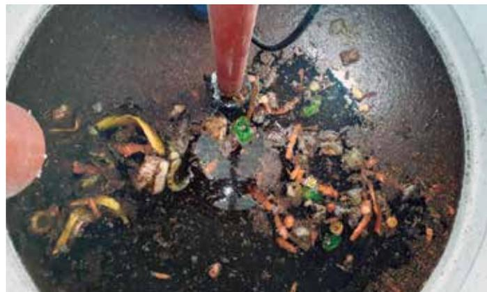
El biodigester permite reciclar residuos para producción de biogas y fertilizantes
