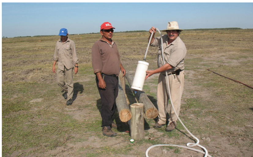
Figura 10. Diseño del chupador flotante para perforaciones con estratificación vertical de sales.
