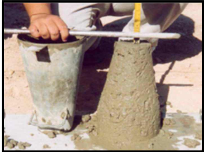
Figura 13. Control del asentamiento con el cono de Abrams. (Fuente: ICPA, 2013).
