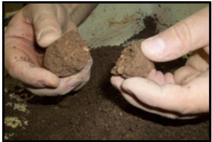
Figura 7. Suelo con contenido de humedad cercano al óptimo: el terrón partido no debe desmenuzarse (muestra de laboratorio).
