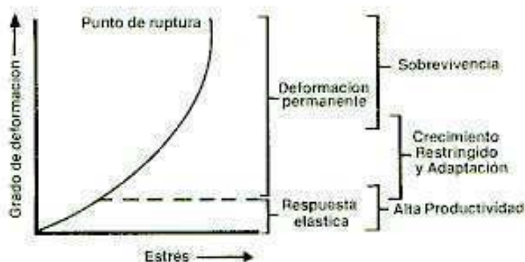
Figura 2. Relación entre la intensidad del estrés y el grado de deformación (Adaptada de Bradford & Hsiao, 1982).
