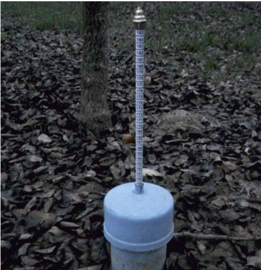
Foto 2. Freatímetro con flotador indicando la distancia a la que se encontraba la capa freática de la superficie del terreno (1,59 m), en el período (junio 2014) en que se regó por aspersión, con agua subterránea, para lavar sales.
