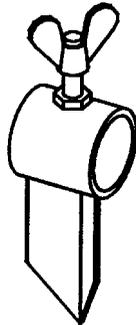
Sobre la cabeza de un bulón de 1/4" y 1" de largo, soldar un tramo de planchuela de 10 mm x 50 mm, que conformará una mariposa fácil de ajustar y aflojar.
