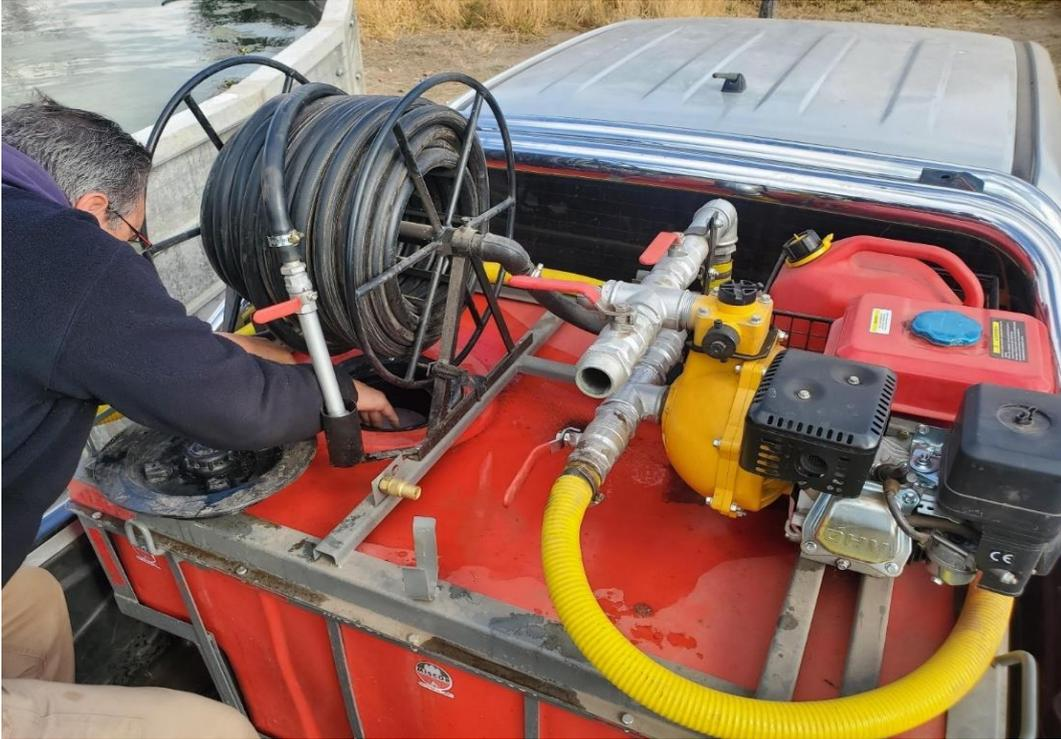
**Figura:** Equipo de Ataque Rápido para control de Incendios Rurales montado en camioneta doble cabina.
