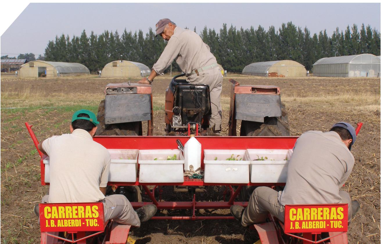
Transplantadora de plántulas de hortalizas de tres puntos, dos hileras de surcos, sistema de pinzas y movimientos accionado por engranajes mecánicos, en suelos con labranza reducida y manejo de residuos en superficie en la EEA San Pedro.
