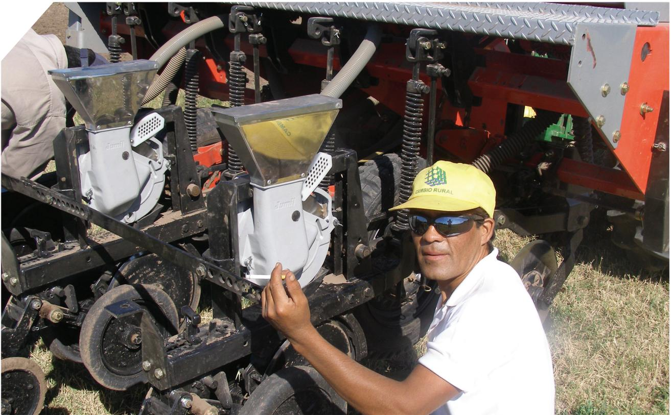
Sembradora neumática de hortalizas JUMIL de acople tres puntos y tres hileras de cultivo, utilizada para la siembra directa de semillas en suelos con labranza reducida y manejo de residuos en superficie en la EEA San Pedro.
