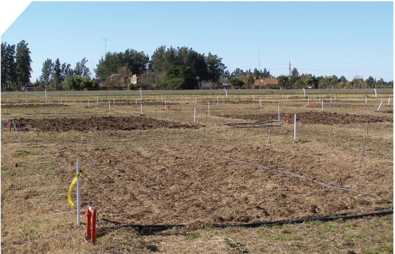
Experimento de la Unidad II, donde se observan las parcelas experimentales de 63 m<sup>2</sup> cada una, con respectivo cabezal individual de riego.
