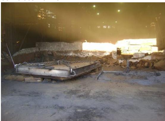
**Figura 14b.** Arena AU desagregada para su reciclado
