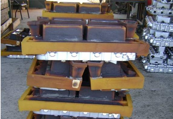
**Figura 16b.** Descartes de ADF SHL separados para muestreo
