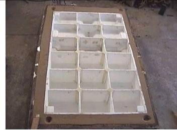
Una vez que se obtiene la resistencia deseada, se gira el molde bajero quedando expuesta la parte del modelo sin copiar.
