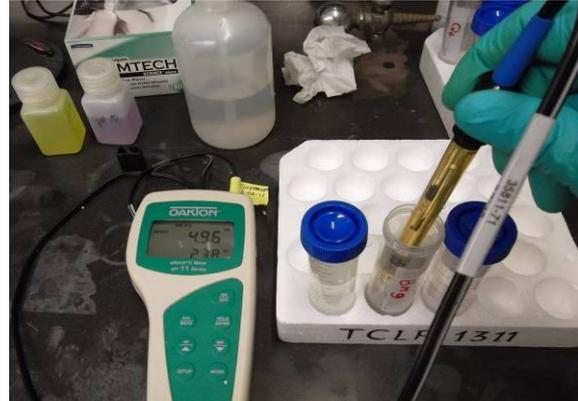
**Figura 26c.** Medición de pH en lixiviado extraído bajo método TCLP
