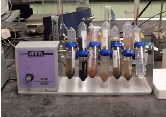
**Figura 26b.** Medición de pH en lixiviado extraído bajo método TCLP
