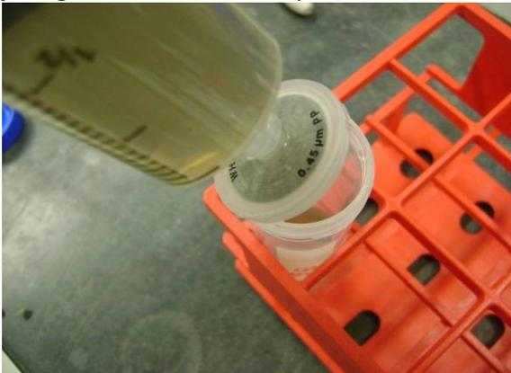
**Figura 27b.** Filtrado de lixiviado TCPL con filtros de fibra de vidrio de  $0,7 \mu\text{m}$
