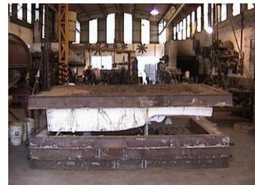
Cuando la arena del molde sobre adquiere resistencia se separa del bajero. Posteriormente se extrae el modelo del molde.
