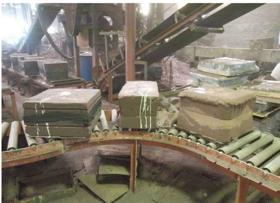
**Figura 15b.** Trituración y separación de finos en ADF FN para su recuperación
