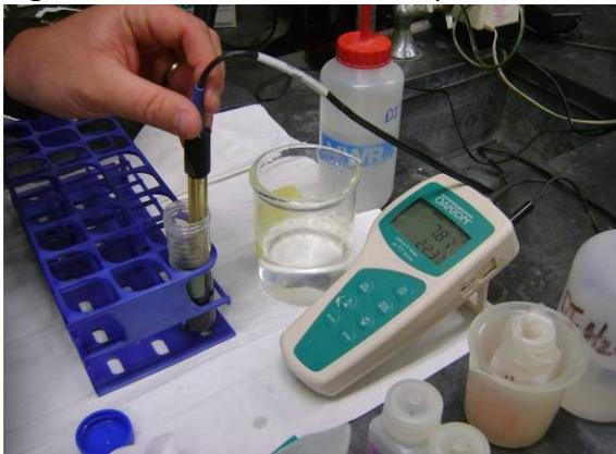
**Figura 20b.** Determinación de conductividad
