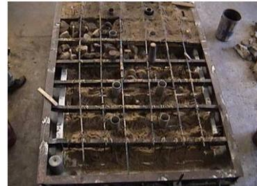
Sobre el molde bajero se coloca un marco metálico que hará de soporte del molde sobre. Posteriormente se incorpora la arena con resina previamente mezclada en molino.
