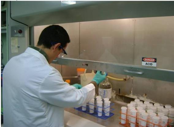
**Figura 23b.** Recipientes de teflón posterior a su digestión en microondas
