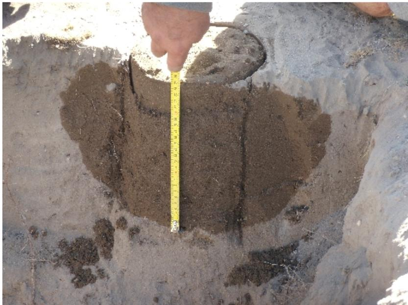
Foto: Medición de ancho y profundidad de la zona humedecida luego de una medición de infiltración realizada en suelo muy seco
