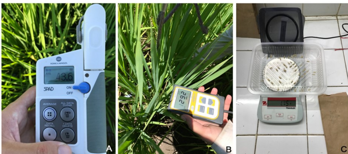
Figura 3. Instrumentos utilizados en las mediciones. A: Equipo medidor de SPAD Minolta; B: Ceptómetro; C: Balanza digital.
