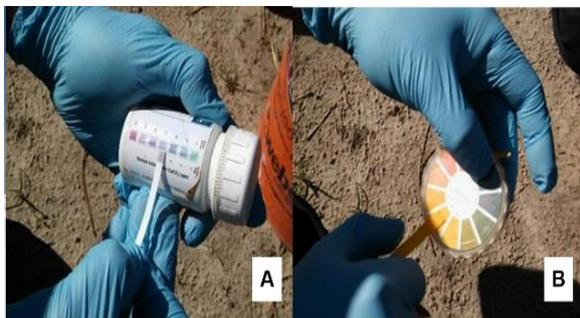
**Figura 3.** Medición de calidad de agua con cintas colorimétricas: A) Nivel de carbonatos (ppm) y B) pH.
