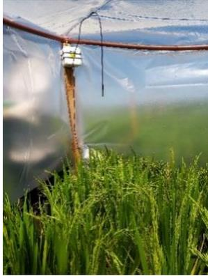
**Figura 4.** Logger utilizado para registro de temperatura.
