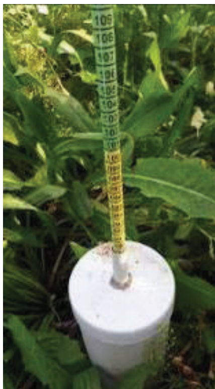
Figura 2: Freatómetro con flotante y varilla graduada, móvil a colores.
