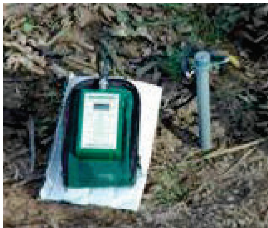
Figura 4: Sensor de humedad de yeso granular enterrado y monitor de registro portátil.
