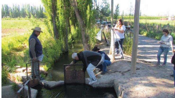
**Figura 22: Practica de aforo en compuerta**
