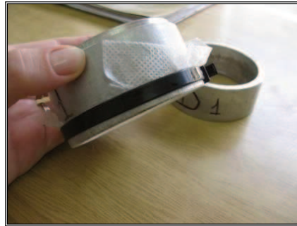
Cilindro inferior con la tela y suncho listo para pesar (Fuente Rilsav)
