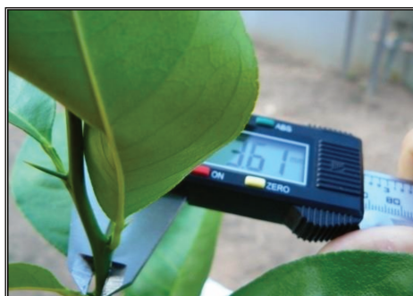
Figura 23- Medición de diámetro de tallo con calibre digital
