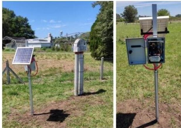
Figura 3.- Prototipo de limnigrafo instalado en el CNIA.
