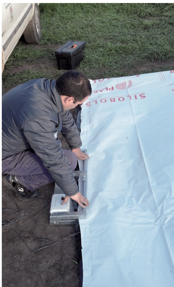
Figura 7. Métodos recomendados para el cierre de la bolsa. Izq.: fotografía del procedimiento de termosellado, mediante una máquina termoselladora. Der.: esquema del cierre por tablas.
