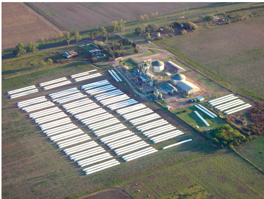
Figura 6: Fotografía aérea de silobolsas. Nótese el correcto agrupamiento de las bolsas en grupos de dos o tres unidades. Esta configuración permite la rápida extracción de cualquier bolsa en caso de detectarse deterioros en la calidad del grano.
