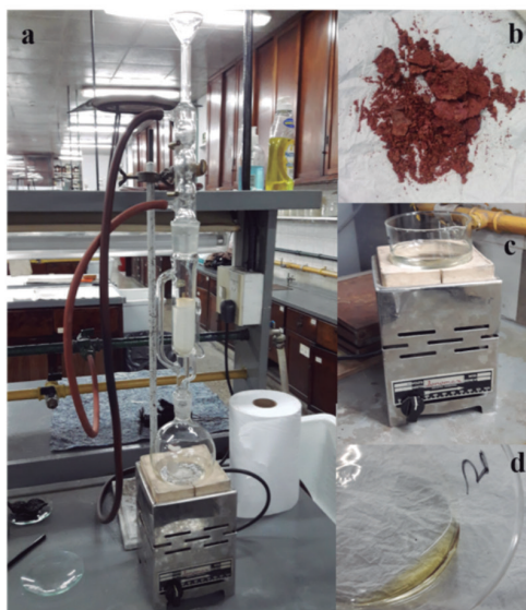
Fig. 8. Método de Soxhlet para extracción de lípidos
