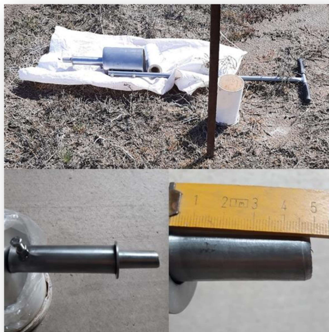
Figura 3. Herramienta usada para la toma de muestra de suelo a dos profundidades: de 0 a 5 cm y de 5 a 20 cm.
