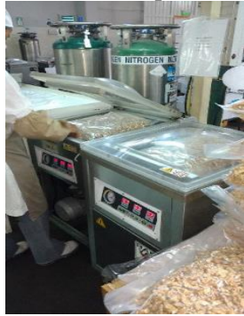
Figura 135. Embolsado a presión e inyección de nitrógeno
