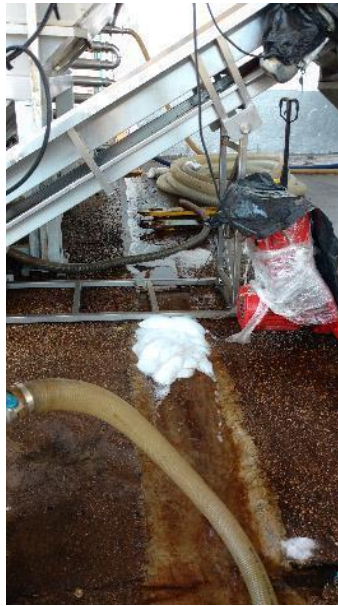
Figura 69. Presencia de productos inusuales en canaletas
