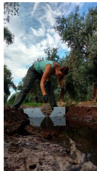
Figura 18. Aforo en vertedero de 60^\circ en canal de tierra
