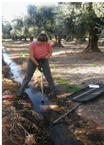
Figura 20. Aforo con micromolinetes en canal de tierra
