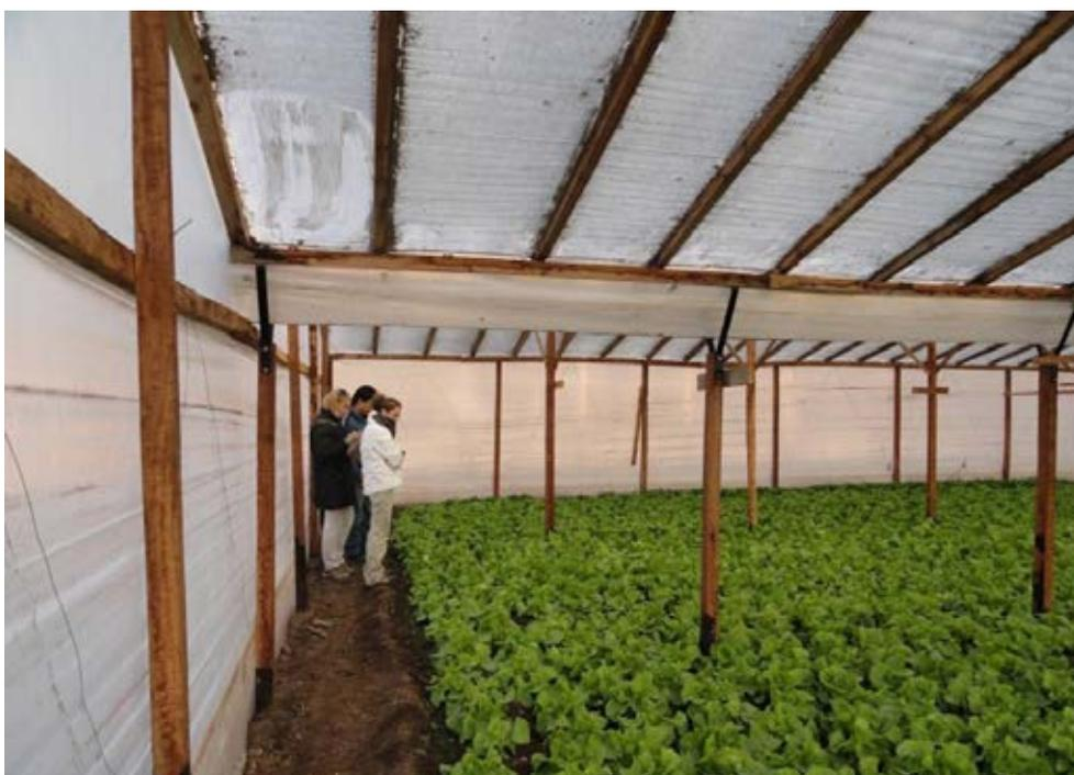
**Foto 34.** Estructura demasiado baja (menos de dos metros de altura en el lateral).
