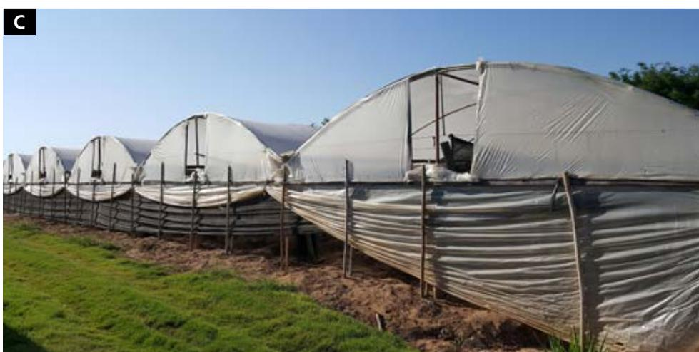
Fotos 19 A, B y C. Apertura frontal cenital en techos rectos (A), Apertura frontal cenital en techos curvos (B). Modo menos eficiente de la apertura frontal. (C)
