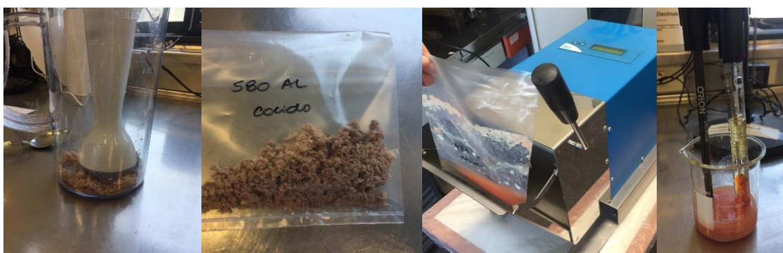
Ilustración 4.6. Procedimiento para la medición del pH en muestra de músculo Semitendinosus .
