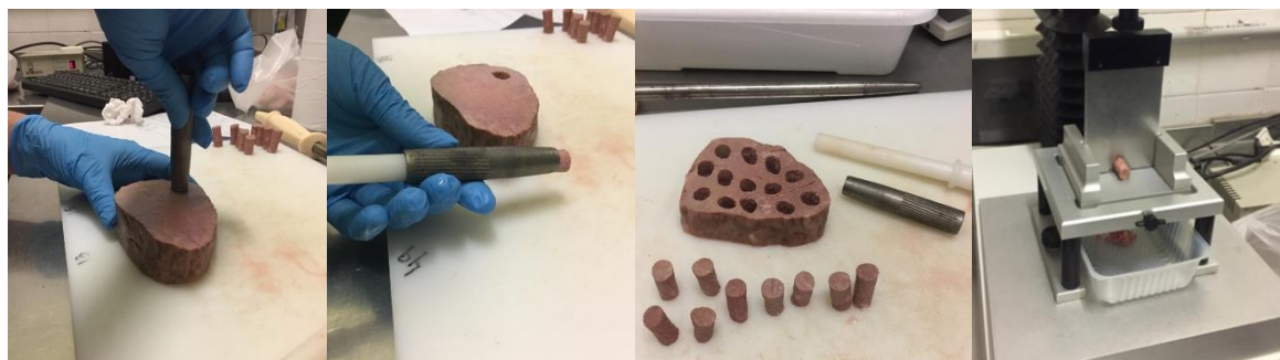
Ilustración 4.8. Medición de la resistencia de corte en muestras de músculo.
