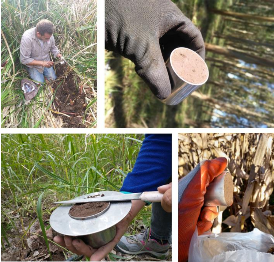
Foto 14.- Toma de muestras de suelos en distintas situaciones para estimar la densidad aparente usando el método del cilindro (Créditos: R. Schincariol, N. Domínguez Daguer, N. Naves y E. Zupan, DNDFI -MAGyP).
