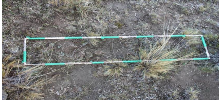
Figura 5. Corte de inter-coironal con marco de 0,2 m 2 mediante el Método Santa Cruz.
