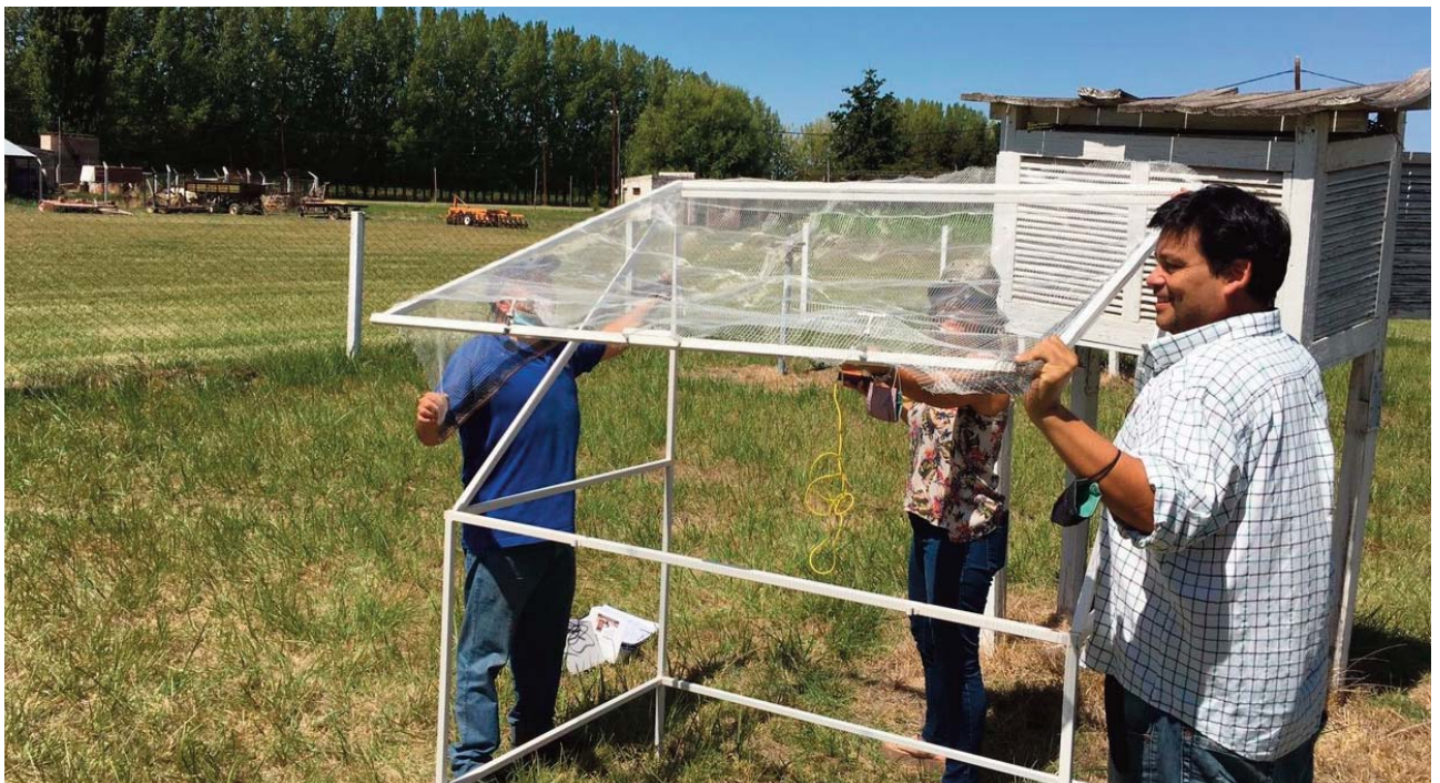
Foto 1. Bastidor utilizado para medir porcentaje de intercepción de radiación PAR de diferentes mallas antigranizo
