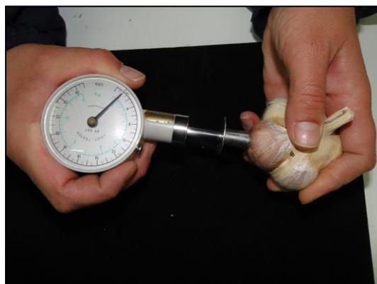
Figura 13 - Medición de la resistencia a la presión
