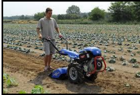
Figura 20: MOTOCULTOR. Sirve para roturar el suelo y hay modelos en donde se puede intercambiar implementos para realizar diferentes tareas.
