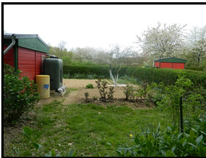
Figura 2: Una Huerta familiar urbana en Rennes, Francia, en el parque público de Gayeulles. Puede verse a la izquierda una casilla para guardar herramientas. Al costado un importante tanque de reserva de agua que se surte con un desagüe proveniente de los techos de la casilla. El agua que recoge es de lluvia.
