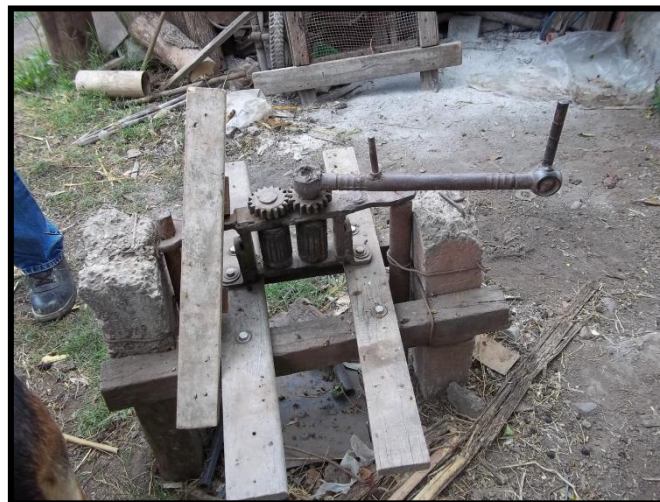
Figura 29: Aquí puede verse el trapiche de Don Coca. Por debajo de las muelas (los cilindros estriados que se ven insertos debajo de los engranajes) se coloca una bandeja con un pico vertedor que por gravedad ayuda a colocar la miel en ollas para luego filtrarla y hervirla, previo a su embasado.
