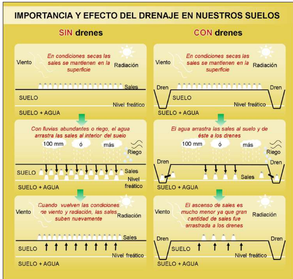
Figura N.º 13. Efecto de los drenes en los suelos (CORFO, 2010).
