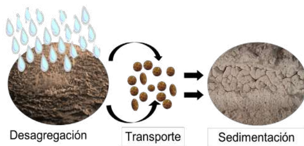
Figura N.º 15. Proceso de erosión hídrica.
