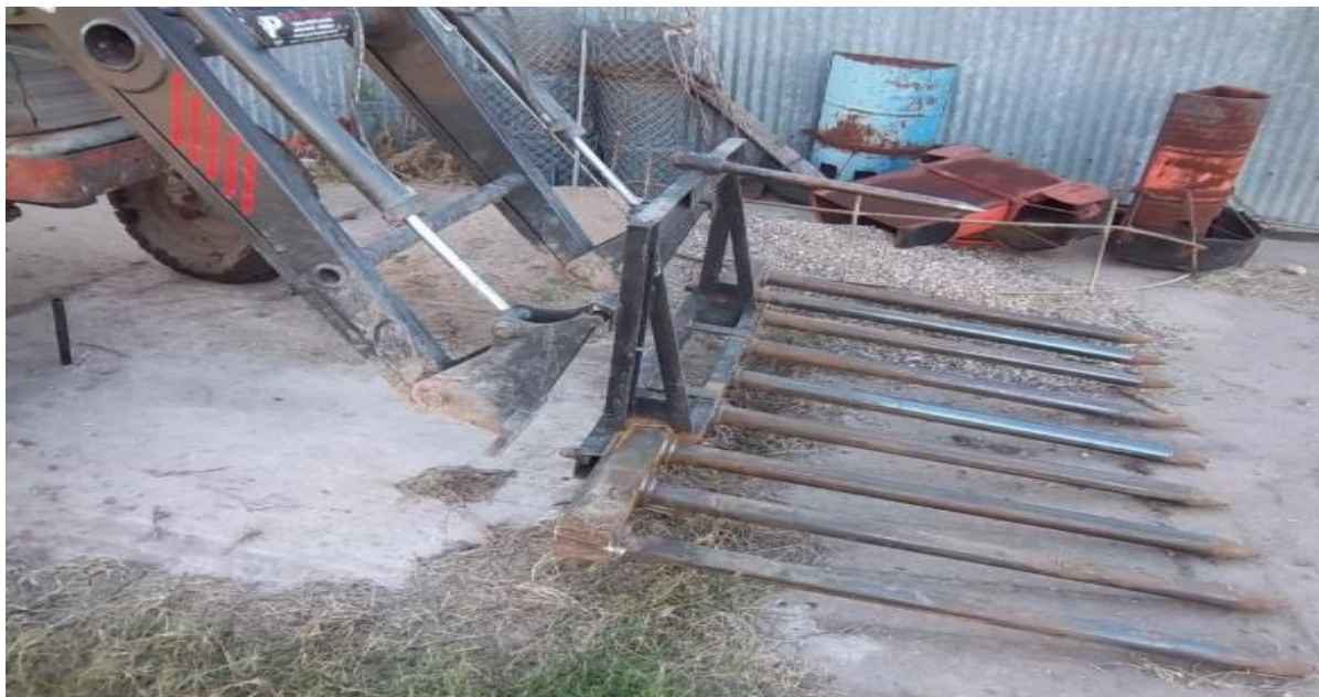
Imagen 17. Herramienta para limpieza de túnel
